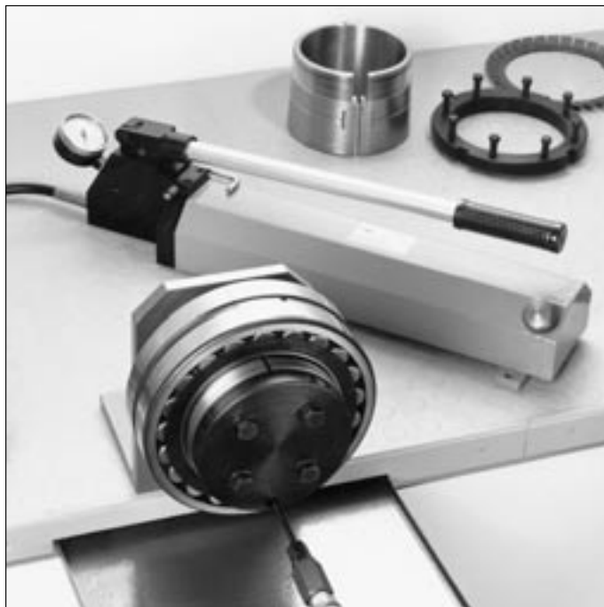
56: Montage af et sfærisk rulleleje med konisk boring efter hydraulikmetoden.
