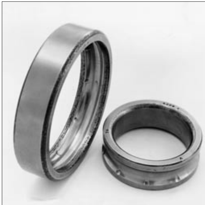
108: Indtrykning af rullelegemerne i løbebanerne på et sporkugleleje fremkaldt ved ukyndig montage.
