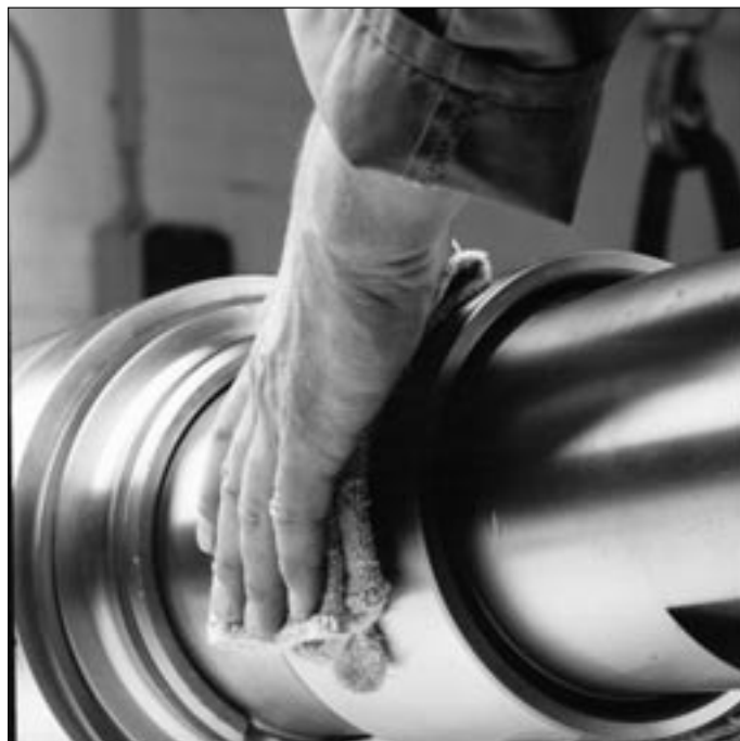
41: Opvarmede lejer skubber man hurtigt og uden kantning indtil anslag. Dette gøres lettere ved en let skruende drejning.
