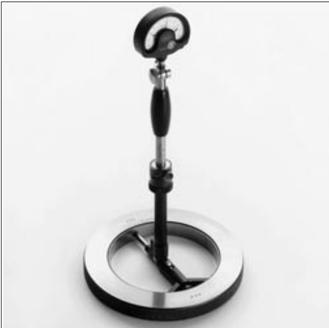
5: Til måling af borerer er især sammenligningsmåleapparater velegnede. Den viste målering bruges til indstillingen.
