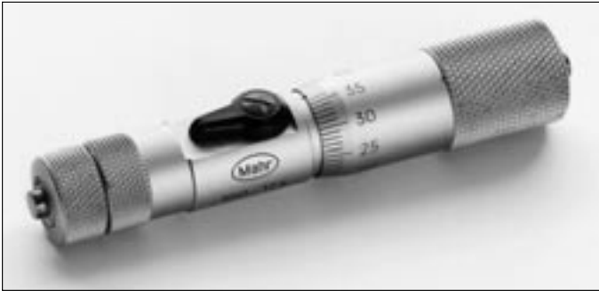
4: Med den indvendige mikrometerskrue måles borerer.
