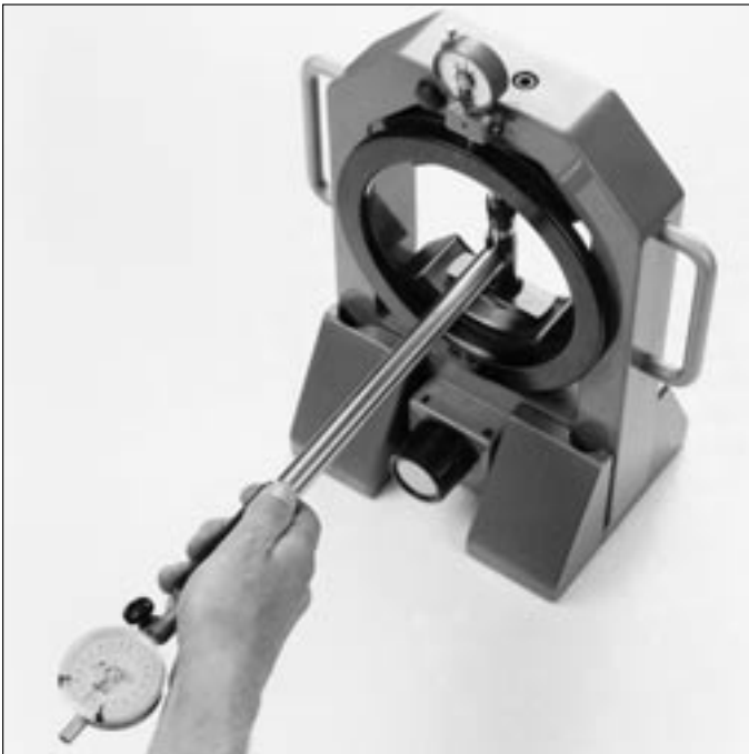
76: Målet på løbebanediameteren overføres med boringsmåleapparatet til rullekransmåleapparatet. Rullekransmåleapparatet FAG MGA 31 anvendes ved cylindriske rullelejer med aftagelig yderring, f. eks. FAG NN30ASK.
