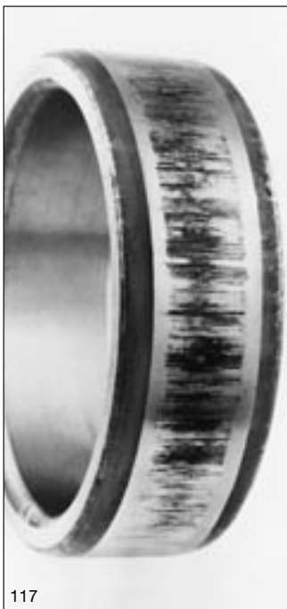
116: Huller, der er opstået p.g.a. stilstandskorrosion i yderlingsløbebanen på et sfærisk kugleleje.
