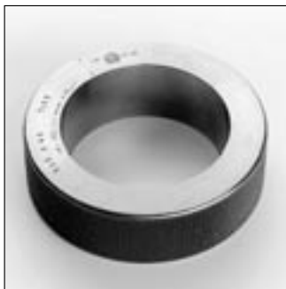
10: Små koniske lejesæder kontrolleres med konuslæring.
